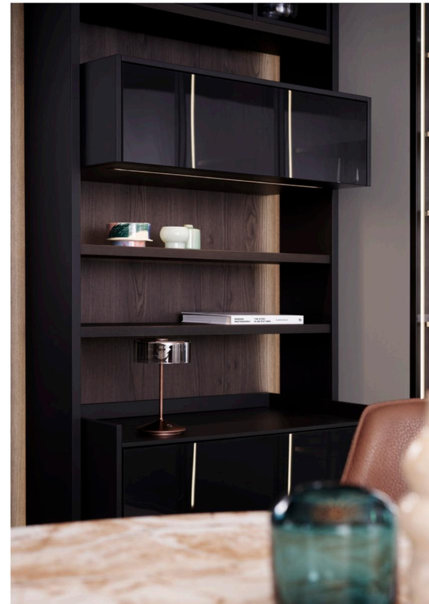
Das offene Regalsystem ICONIC ist durch ein entscheidendes Detail charakterisiert: Die vertikalen Regalseiten stehen mit einem minimalen 5 cm Abstand von der Wand entfernt. Dahinter verläuft ein LED-Lichtband, das eine dreidimensionale Wirkung erzeugt.
